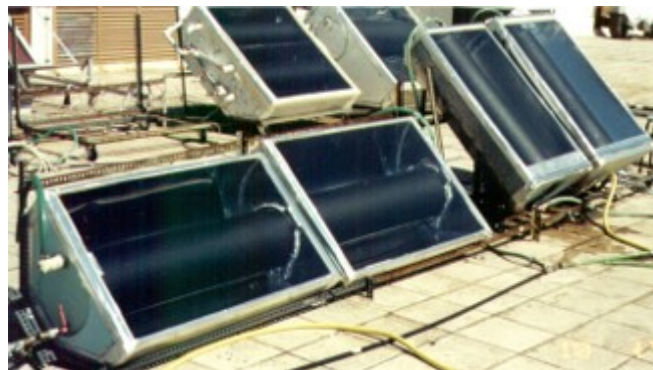
/export/sites/universitat-lleida/ca/serveis/c Prototips del col·lector parabòlic / FOTO: M. Souliotis
