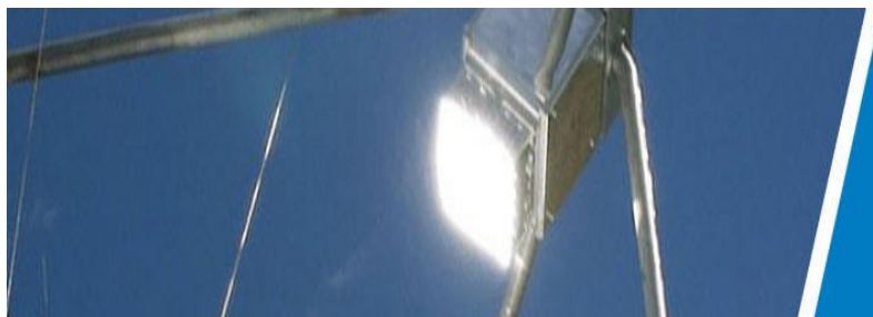
Figura 1: Receptor de matriu densa de cèl·lules fotovoltaiques d'alta concentració
