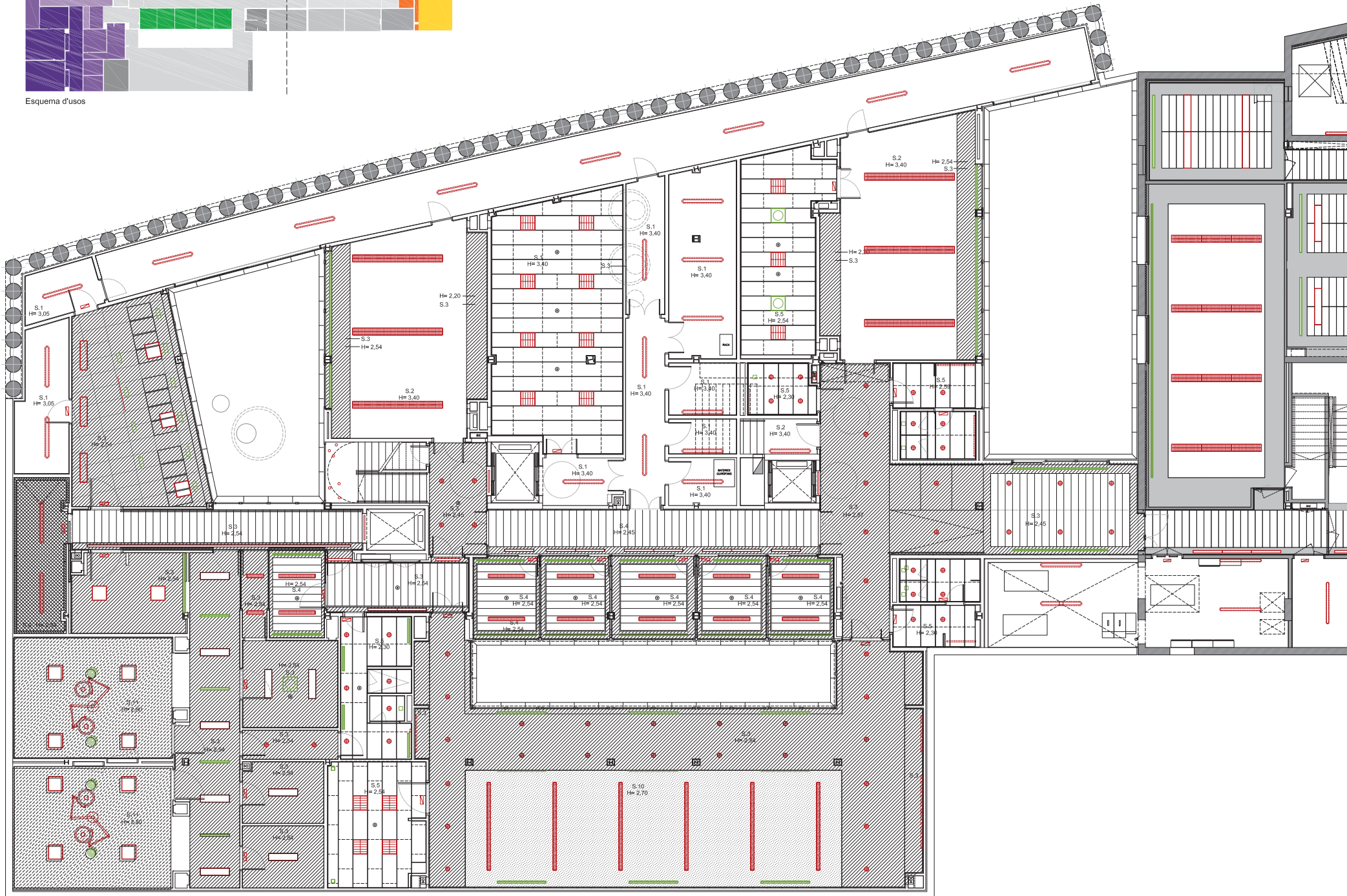
PLANTA SOTERRANI - FALSOS SOSTRES E/1/100
